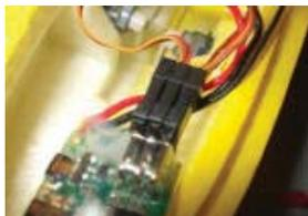
Voici à quoi ressemblera la connexion. Remettez en place la CVE et acheminez les fils de façon à ce qu'ils ne touchent pas aux servos.
