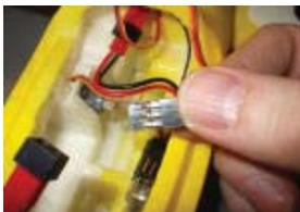
Faites glisser le raccord sur les chevilles en maintenant le côté argenté vers le bas.
