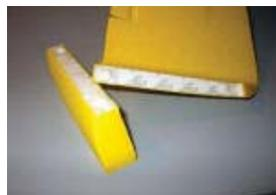
Installez ensuite l'extrémité de l'aile. Trouvez la petite extrémité et retirez le ruban 3M de l'aile.
