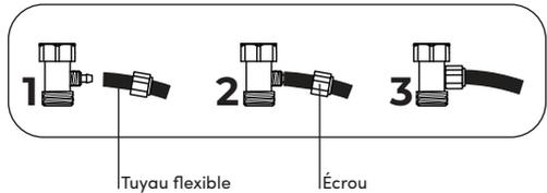
Connectez l'adaptateur en simple en plastique de l'autre côté du tuyau. Pensez à faire passer la partie n°1 avant la partie n°2 autour du tuyau.
