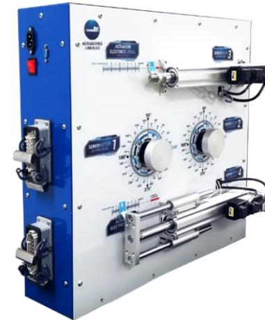
Un demo dedicado al movimiento preciso, los actuadores lineales son utilizados para realizar esta conversión de movimiento, tal es el caso lineales SMC-DELTA, los cuales aprovechan la precisión de los Servomotores DELTA para brindar un movimiento estable y de gran exigencia.
