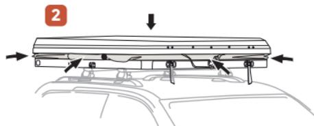
Para el cerrado de la carpa, te recomendamos mantener las ventanas abiertas (asegurate que la tela quede dentro), así se descomprime el interior de la carpa y se facilita el cierre de esta.
