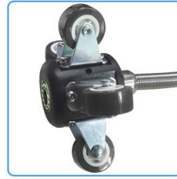
3. Atornille los 3 tornillos blancos de la carcasa protectora hasta que quede fija en el cabezal de la cámara
