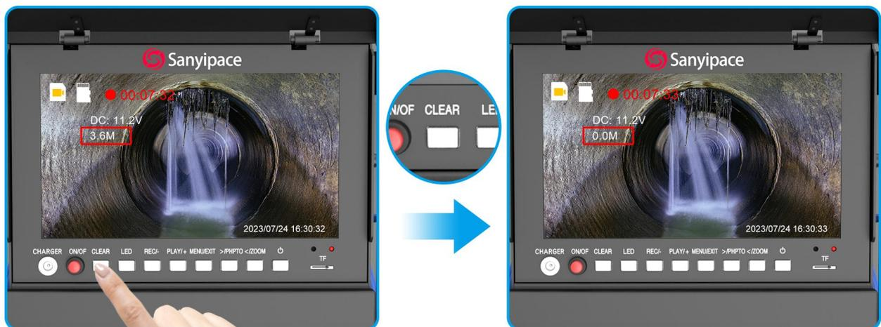
Bevor Sie die Meterzählerfunktion verwenden, drücken Sie bitte die TASTE "CLEAR", um die Zählinformationen zurückzusetzen. Sie können die Anzeige zwischen Fuß und Meter umschalten, indem Sie die Taste F4 drücken. Die Zählung von Fuß/Meter beginnt, wenn die Spule sich dreht, und die Anzeige erfolgt in Echtzeit auf dem Bildschirm.
