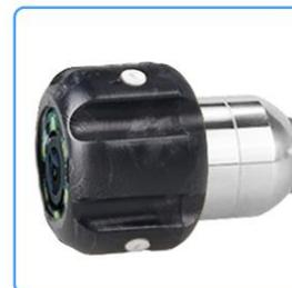
Esta sonda con cámara de 0,9 pulg./23 mm de diámetro lleva incorporado un transmisor de 512 Hz, que transmite una señal de frecuencia de 512 Hz a través de un chip integrado, compatible con cualquier localizador de tuberías de 512 Hz.
