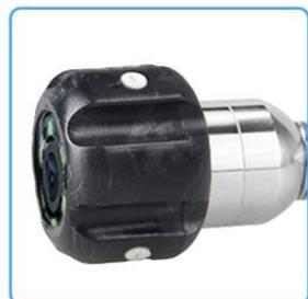
Diese Kamerasonde mit einem Durchmesser von 0,9 Zoll/23 mm hat einen eingebauten 512-Hz-Sender, der ein 512-Hz-Frequenzsignal über einen eingebauten Chip sendet, der mit jedem 512-Hz-Rohrortungsgerät kompatibel ist.
