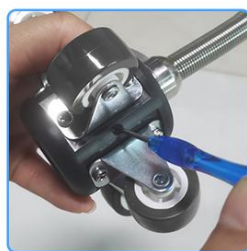
2. Coloca la funda protectora de la cámara en el cabezal de la cámara
