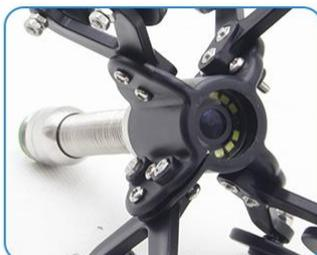
2. mettere la puleggia della fotocamera sulla sonda della fotocamera
