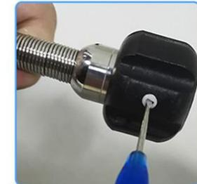
2. Coloque la funda protectora de la cámara en el cabezal de la cámara.
