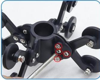
1. afloje los 4 tornillos y expandir el espacio de la polea de la cámara
