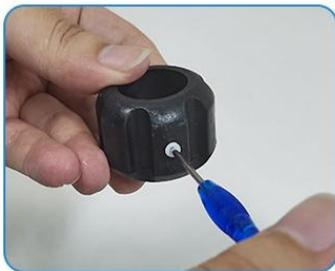
1. use el destornillador para aflojar los tornillos blancos
