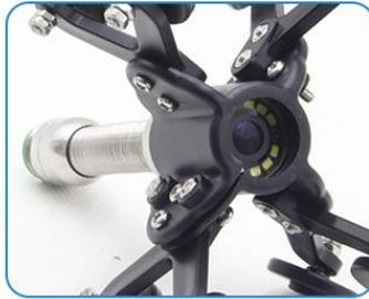
2. coloque la polea de la cámara en la sonda de la cámara
