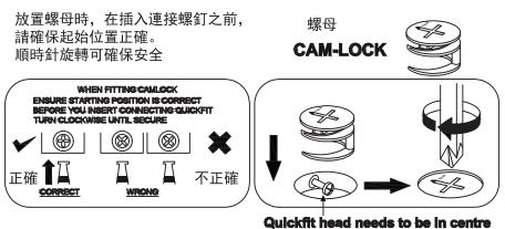
Quickfit head needs to be in centre 螺釘的頭部必須在中心
