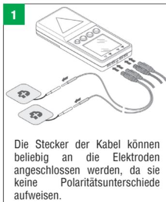
Die Stecker der Kabel können beliebig an die Elektroden angeschlossen werden, da sie keine Polaritätsunterschiede aufweisen.
