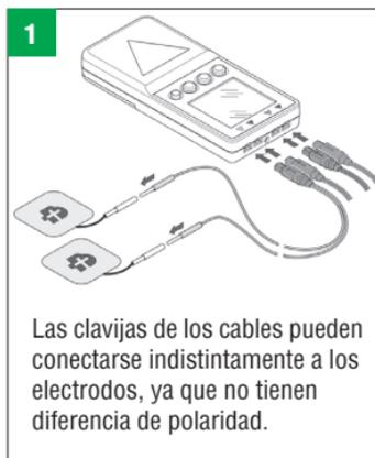
Las clavijas de los cables pueden conectarse indistintamente a los electrodos, ya que no tienen diferencia de polaridad.
