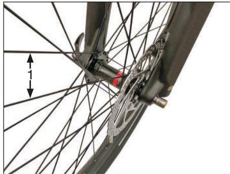
Il est important que les rayons (1) soient bien ajustés pour assurer le bon fonctionnement des roues. Les rayons peuvent se desserrer avec le temps, resserrez-les si nécessaire.
