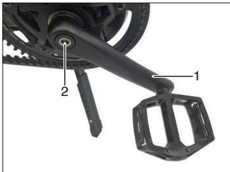
Les manivelles (1) peuvent se desserrer avec le temps pendant la conduite. Vérifiez régulièrement si les manivelles sont serrées. Pour effectuer ce contrôle, déplacez vigoureusement les manivelles latéralement. Aucun jeu ne doit être ressenti.
