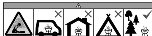
Ne pas faire fonctionner dans des locaux fermés et/ou habitables, par exemple des bâtiments, tentes, caravanes, mobile-homes ou bateaux. Danger d'empoisonnement au monoxyde de carbone.
