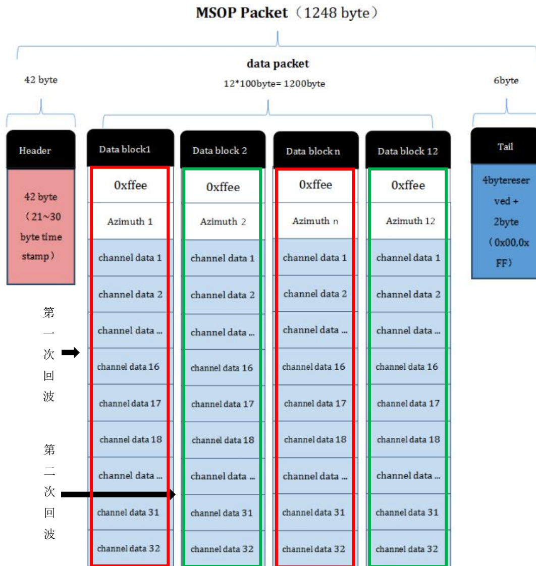
图 6 双回波 MSOP Packet 数据包定义示意图
