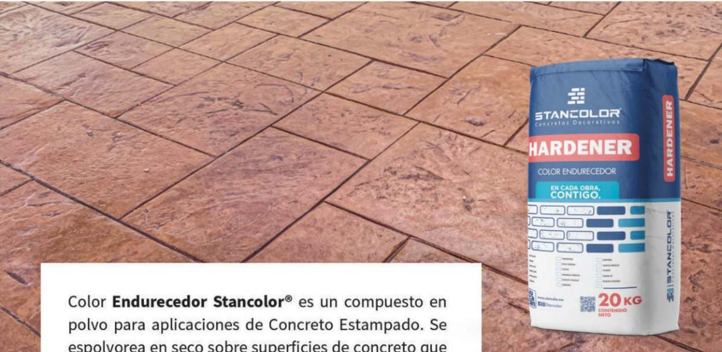
Color **Endurecedor Stancolor®** es un compuesto en polvo para aplicaciones de Concreto Estampado. Se espolvorea en seco sobre superficies de concreto que estén en el inicio de su fraguado, proporcionando un acabado de color y una capa de alta resistencia a la abrasión, sobre la que se aplican diversos patrones de estampado.
