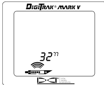
Exhibición de la frecuencia del receptor luego de soltar el disparador
