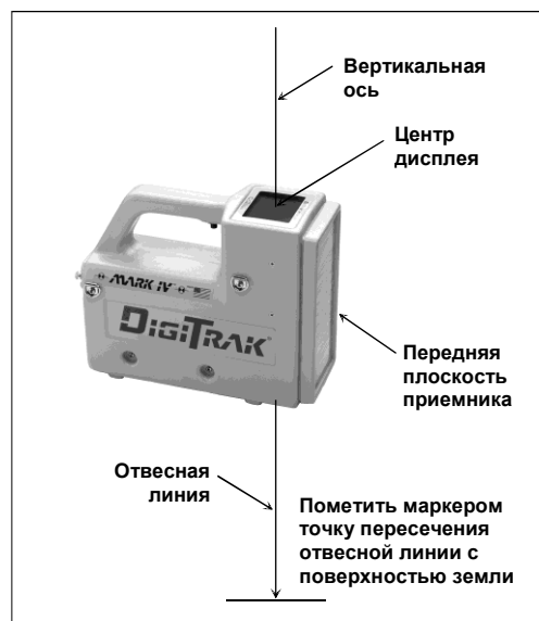
Отвесная линия для маркировки точек локации
