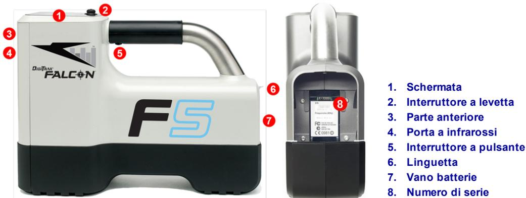
Ricevitore Falcon F5 – vista laterale e posteriore
