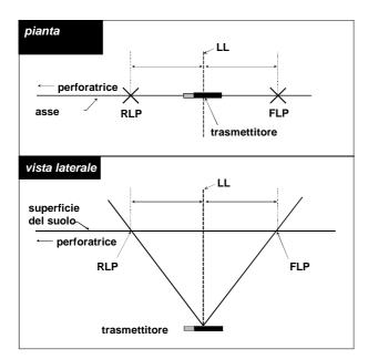
Pianta e vista laterale di FLP, RLP, ed LL quando il trasmettitore e la superficie del suolo sono paralleli ed orizzontali
