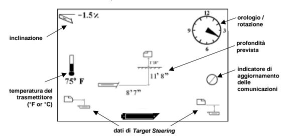
Visualizzazione della Profondità Prevista sul Display Remoto (quando il ricevitore è sul FLP o sul RLP)
