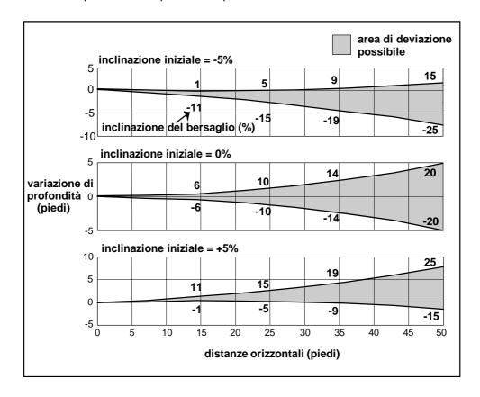
Diagramma delle aree di deviazione possibile per il sistema a cavo (unità anglosassoni)
