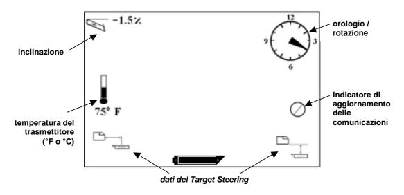
Schermata del Display Remoto (quando il ricevitore non è sulla verticale di FLP, RLP, o LL)
