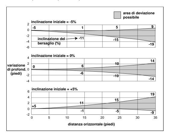
Diagramma delle aree di deviazione possibile (unità anglosassoni)
