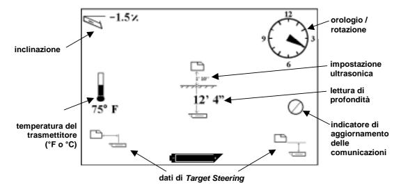
Visualizzazione della Profondità sul Display Remoto (quando il ricevitore è sulla verticale della LL)
