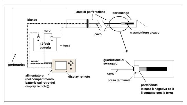
Connessione dei componenti del sistema a cavo
