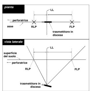
pianta e vista laterale di FLP, RLP, ed LL quando il trasmettitore ha un'inclinazione negativa
