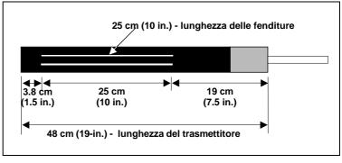
Geometria delle fenditure nei trasmettitori a cavo
