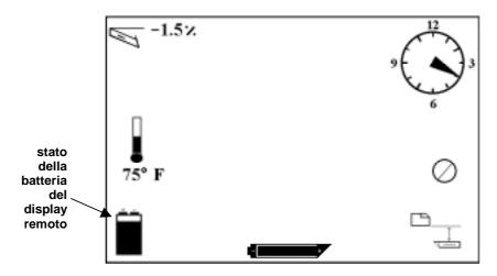
Stato della batteria del display remoto
