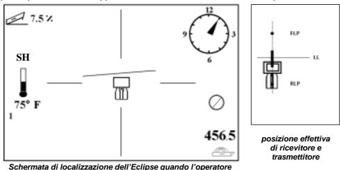
5. Muoversi con il ricevitore fino a quando la LL non risulta allineata con le linee orizzontali del mirino. A questo punto siete sulla verticale della LL. Per determinare l'esatta posizione laterale del trasmettitore è necessario a questo punto trovare FLP.
