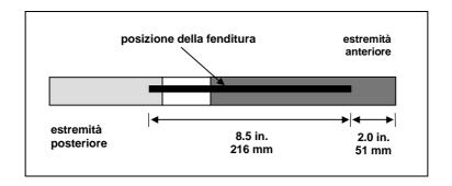
Caratteristiche delle fenditure nel portasonda
