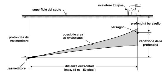
Area di deviazione possibile con il sistema a cavo
