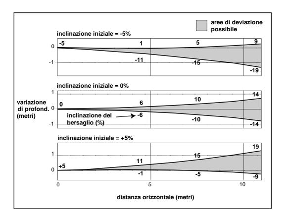
Diagramma delle aree di deviazione possibile (unità metriche)
