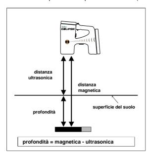
Uso del misuratore ad ultrasuoni per la determinazione della profondità effettiva.
