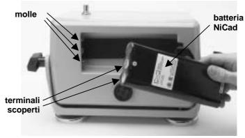
Installazione della batteria nel display remoto
