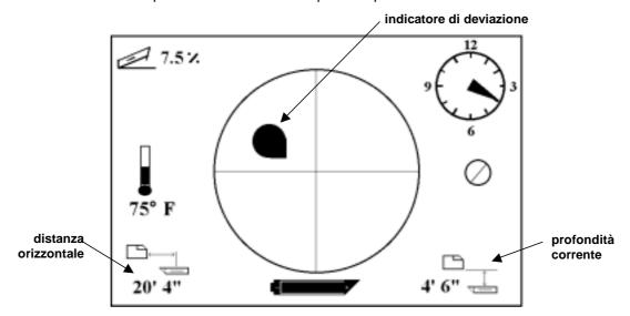
Schermata del Target Steering sul Display Remoto
