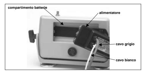
Inserimento dell'alimentatore nel display remoto
