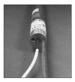
Trasmettitore a cavo con l'estrattore/inseritore avvitato all'estremità
