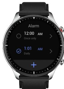
Si no hace nada y el reloj vibra durante 30 segundos, la alarma se pospone automáticamente.
