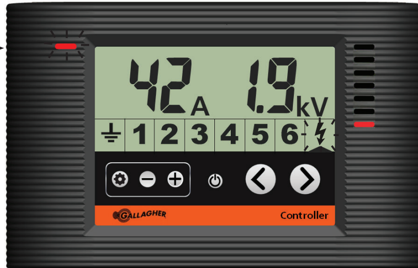
Contrôleur affichant une alarme Intensité sur l'électrificateur
