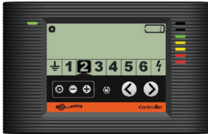
Controlador mostrando la zona 2 con batería baja
