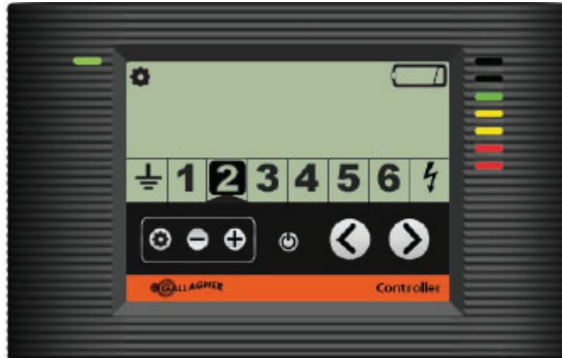
Kontroll visar zon 2 med en låg batterinivå
