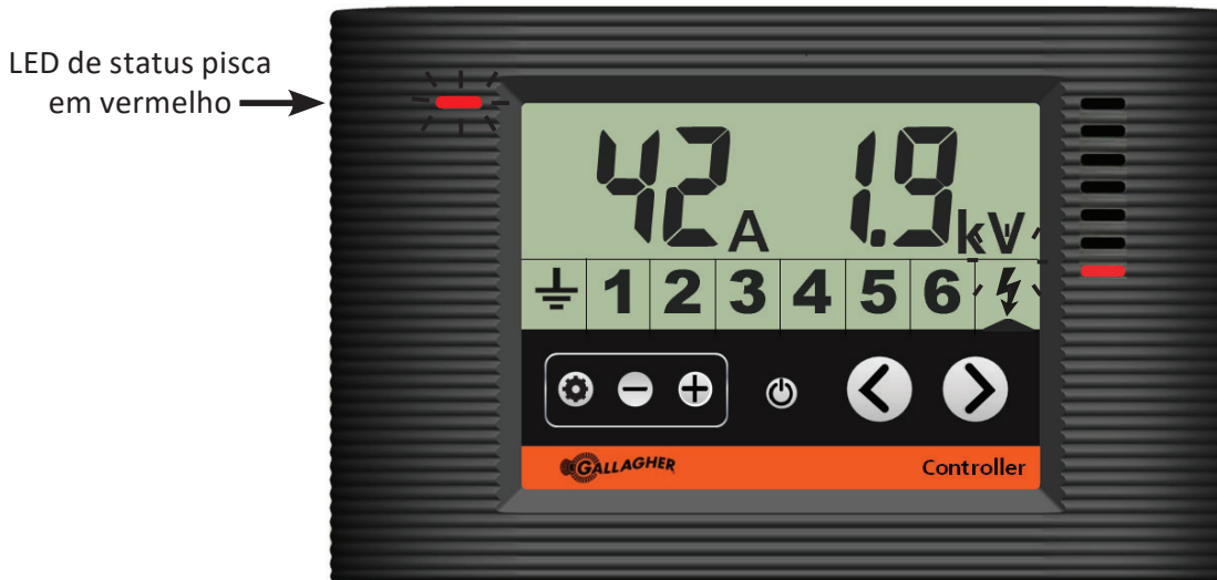
Controlador mostrando o energizador no alarme de corrente
