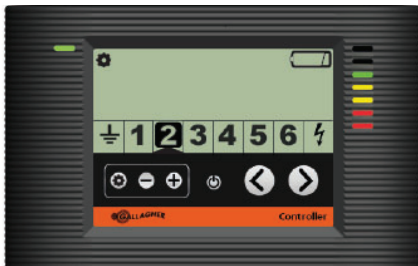
Il display mostra che il terminale della zona 2 ha la batteria scarica.
