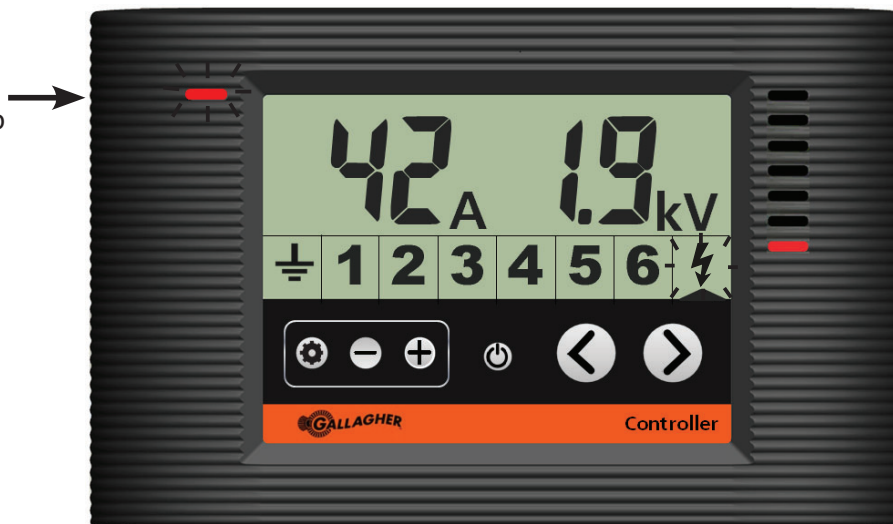
Il display mostra l'elettrofornace in allarme corrente
