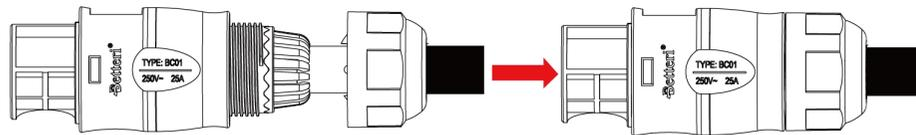
B) Schließen Sie das AC-Endkabel an den AC-Stecker des ersten Mikrowechselrichters an, um den Kreislauf fertigzustellen.
