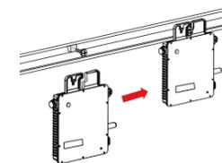
*\*Hinweis: Bitte installieren Sie den Mikrowechselrichter mindestens 50 cm über dem Boden/Dach zur besseren Kommunikation mit dem DTU von Hoymiles.*
