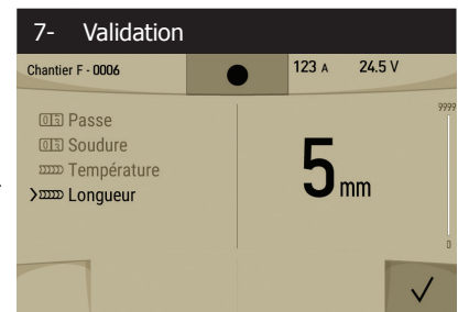
La validation peut s'effectuer sur l'IHM ou par appui sur la gâchette.
