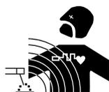
Le courant électrique passant à travers n'importe quel conducteur produit des champs électriques et magnétiques (EMF) localisés. Le courant de soudage produit un champ électromagnétique autour du circuit de soudage et du matériel de soudage.
