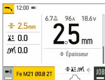
IHM - dévidoir actif
