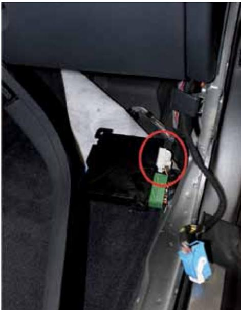
Entfernen Sie nun beide Stecker auf der oberen Seite des Steuergerätes. Die Stecker sind durch einen verrasteten Einziehbügel gegen Herausrutschen gesichert. Dieser Bügel lässt sich nach Eindrücken des Rasthakens auf der Oberseite öffnen. Dabei wird der Stecker automatisch aus seiner Fassung gelöst.
