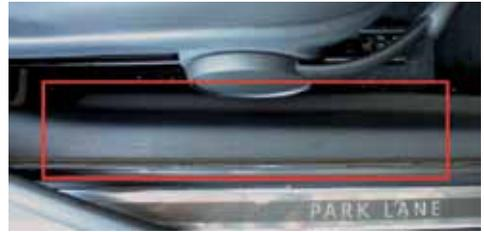
Lösen Sie die Spreiznieten, indem Sie mit einem Montagekeil oder einem flachen Schraubendreher den inneren Teil ca. einen Zentimeter weit herausdrücken. Nun kann die ganze Spreizniete herausgeholt werden.
