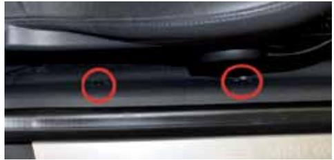
Die Verkleidung der Einstiegsleiste wird durch innenliegende Clips an der Karosserie gehalten. Ziehen Sie die Verkleidung, beginnend mit der Kante am Hebel der Motorhaubentriegelung, mit Kraft in Richtung Beifahrerfußraum. Entfernen Sie die Verkleidung bis etwa zum Beifahrersitz und fixieren Sie diese durch Einklemmen unterhalb des Handschuhfachs.
