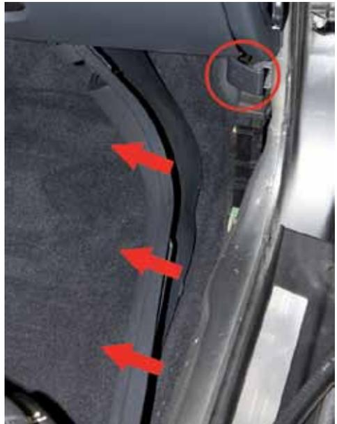
Entfernen Sie die zurückgebliebenen Befestigungsclips aus der Karosserie und bewahren Sie diese für die Endmontage auf.
