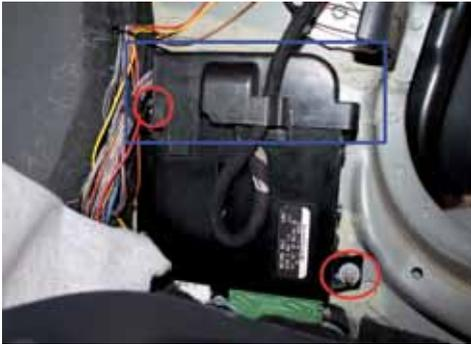
Nun wird das Steuergerät wieder mit den beiden Muttern verschraubt. Setzen Sie den Deckel auf die Zentraleinheit und fixieren Sie den vorderen Kabelbaum wie abgebildet an dem Clip des Deckels.
