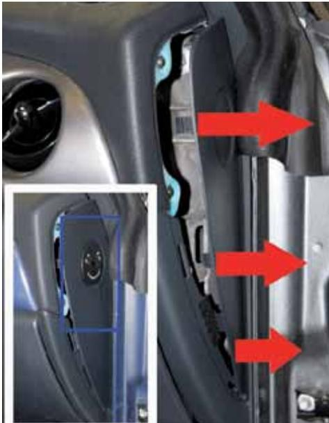
Als nächstes wird die Seitenverkleidung des Armaturenbretts entfernt. Diese ist nur gesteckt und kann mit etwas Zug in Richtung der Beifahrertüre gelöst werden. Achten Sie dabei darauf, die Rastnasen nicht abzubrechen.
