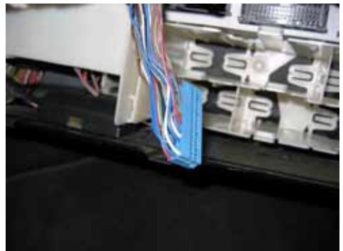
Rasthaken beidseitig wegdrücken, dann Buchsenleisten aus dem Steckergehäuse ziehen.
