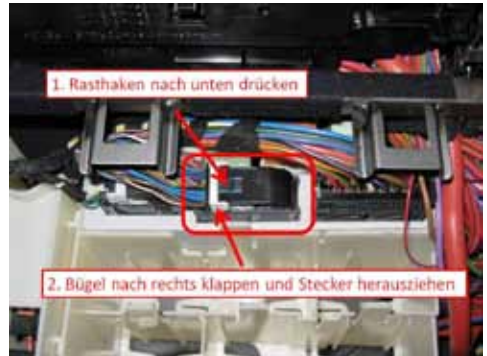
Durch Umlegen des weissen Einziehbügels nach rechts wird der Stecker vom Steuergerät gelöst.
