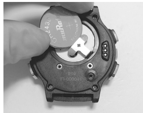
INSTALAÇÃO DA BATERIA
