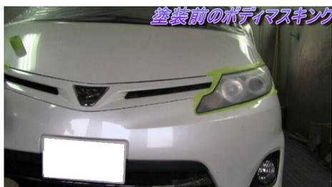
① 研磨の工程同様、最初にヘッドライト周りにマスキングをします。
