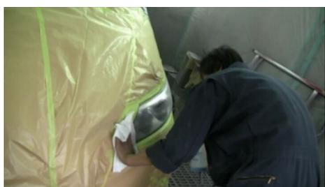
ヘッドライトカバーを脱脂し、ウエスで吹き上げた後、タッククロス等で吹き上げます。
