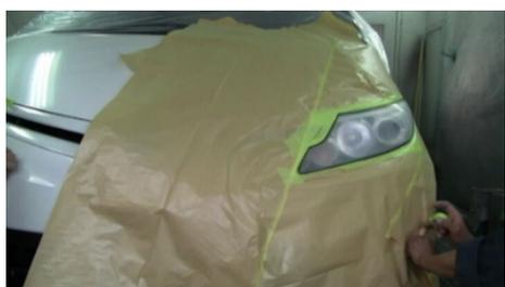
② 次にボディー面に養生シートを張ります。コーティング剤が飛散しそうな場所だけの養生でもよい。
