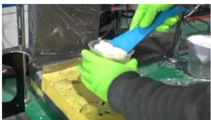
a. Glanz neo(以下、パテ)を計量する
