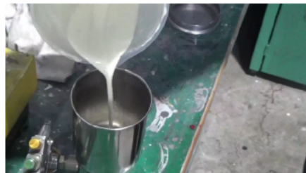
f. スプレーガンに投入 ・口径 1.2mm 以下推奨 ・口径 1.5mm 以上の場合、チッピングコートのような肌になります。
