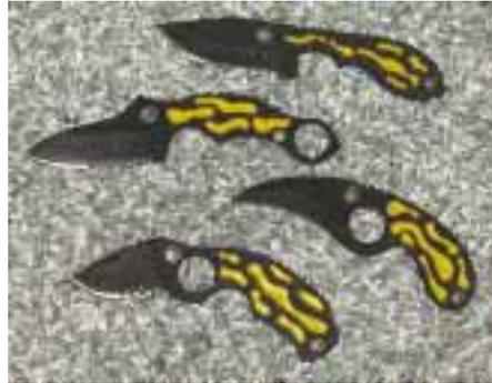
Mit dieser Familie der Custom Knives schafft Remund wirkliche Leichtgewichte mit sehr aggressiver Optik. Die Messer bestehen aus einem nur ein Millimeter starken Titankern, der von beiden Seiten komplett mit etwa drei Millimeter G10 laminiert wurde. So erreicht Remund die nötige Stabilität, das G10 wird hier an der Klinge mit ausgeschliffen, nur an der eigentlichen Schneide liegt das Titan blank. Diese „giftigen“ Messer wiegen je nach Modell nur zwischen 46 und 59 Gramm.
