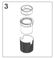
3. 將冰泣淋碗放入碗容器中, 並在碗頂部 4. 將攪拌杆裝入主機 安裝操作窗。
