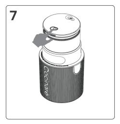
7.開關機,長按1.5秒,20分鐘後自動停機, 8 燈光閃爍3S,蜂鳴器長滴一聲; 過程中可通過視窗透明口觀察冰淇淋狀態。
