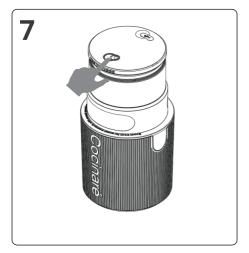
7.ボタンを1.5秒長押しして電源を入れると、 撹拌羽根が動作し始めます。20分後に 自動的に停止し、ライトが3秒間点滅 してビープ音がなります。制作中は覗き窓 からアイスクリームの様子を確認できます。
