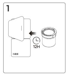
1. イスクリームボウルを凍らせる。 使用前に12時間、-18℃/-0.4°Fの温度 で保管する。
