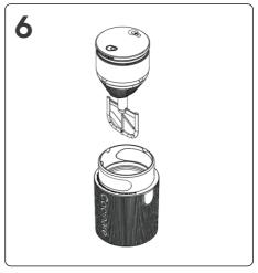
6.準備好碗中的配料後,通過調整操作窗口的槽,將攪拌機(帶電機頭)放入碗中。
