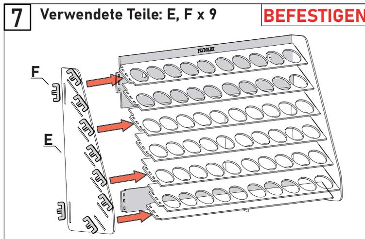
Montieren Sie die zweite E Teile gemäß der Abbildung. Für mehr Komfort können Sie den Organizer vertikal stellen. Befestigen Sie mit den Elementen F (wie im Schritt 3 gezeigt).
