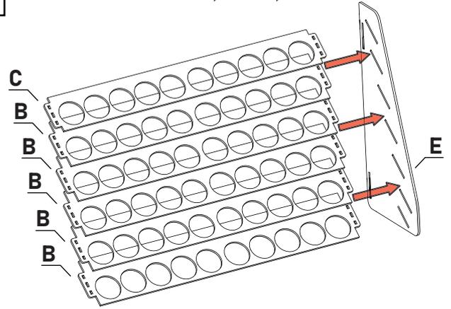
Montieren Sie die Teile C und B x 5 in der Nute von Teil E gemäß der Abbildung.
