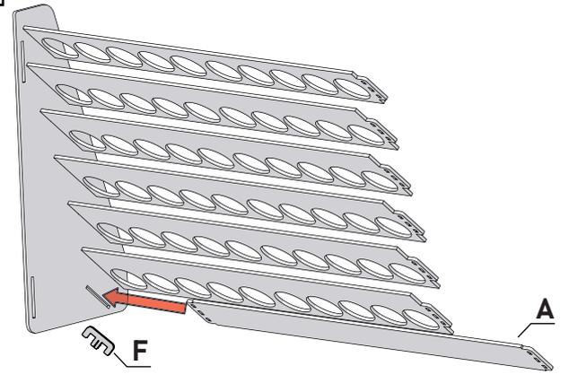
Drehen Sie den Organizer mit der Rückseite zu sich hin und montieren das Teil A in der Nute von Teil E. Befestigen Sie mit das Element F (wie im Schritt 3 gezeigt).
