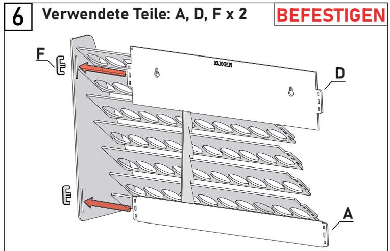
Montieren Sie die Teile A und D gemäß der Abbildung. Befestigen Sie die montierte Teile mit den Elementen F (wie im Schritt 3 gezeigt).
