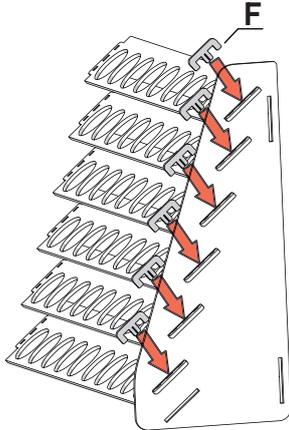
Befestigen Sie die montierte Teile mit den Elementen F.
