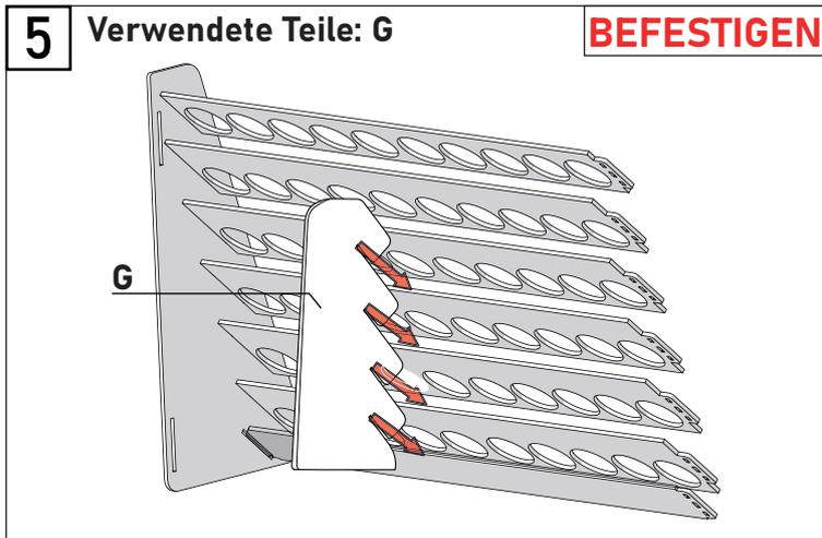
Montieren Sie das Teil G gemäß der Abbildung. Für mehr Komfort können Sie den Organizer vertikal stellen (E-Seite nach unten).
