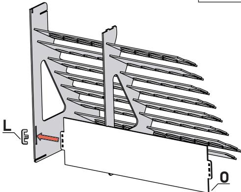
Montieren Sie das Teil O in der Nute von Teil I und befestigen mit dem Element L (wie im Schritt 2 gezeigt).
