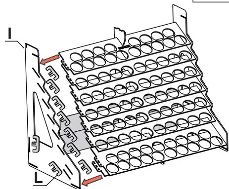
Montieren Sie das zweite Teil I. Befestigen mit den Elementen L (wie im Schritt 2 gezeigt).
