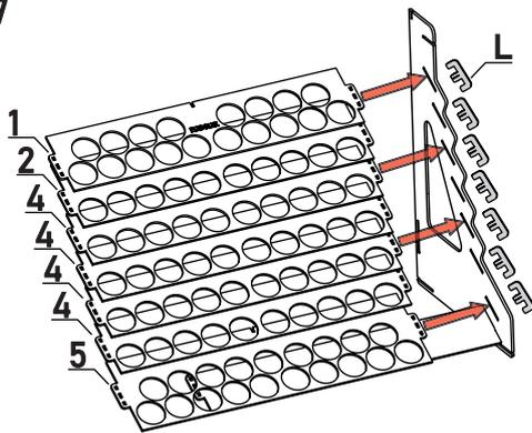
Montieren Sie die Teile 1, 2, 4 x 4 Stk., 5 in der Nute von Teil I gemäß der Abbildung. Befestigen Sie die montierte Teile mit den Elementen L (wie im Schritt 2 gezeigt).
