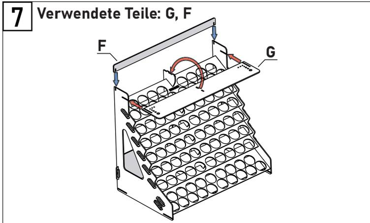
Montieren Sie zunächst das Teil G, wie abgebildet. Heben Sie es in der Mitte leicht an, damit das Teil an seinen Platz passt. Montieren Sie dann das Teil F.
