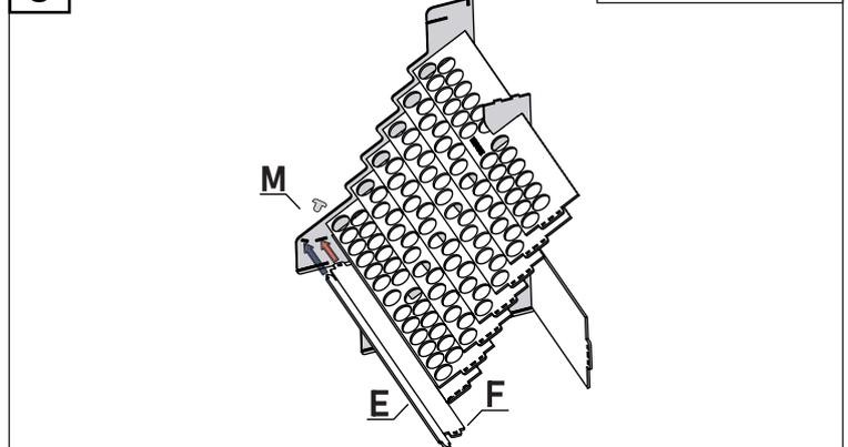
Drehen Sie den Organizer nochmal - mit der Vorderseite zu sich, und montieren die Teile E und F. Befestigen das Teil F mit dem Element M (wie im Schritt 3 gezeigt).
