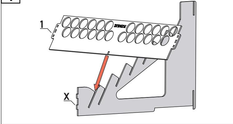
Montieren Sie das Teil 1 in der Nute von Teil X gemäß der Abbildung.
