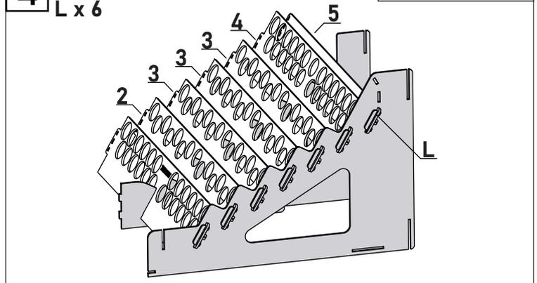
Montieren Sie die Teile 2, 3 x 3 Stk., 4 und 5 gemäß der Abbildung. Befestigen Sie die montierte Teile mit den Elementen L (wie im Schritt 3 gezeigt).
