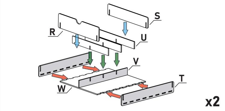
Bauen Sie die beiden Schubladen gemäß der Abbildung zusammen. Bitte beachten Sie, dass das Kit 4 Trennwände (Teil U) enthält. Mit ihrer Hilfe können Sie die Größe der Innenschubladen anpassen.
