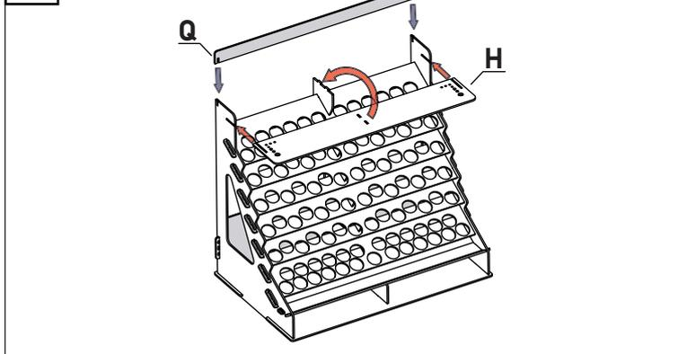
Montieren Sie zunächst das Teil H, wie abgebildet. Heben Sie es in der Mitte leicht an, damit das Teil an seinen Platz passt. Montieren Sie dann das Teil Q.
