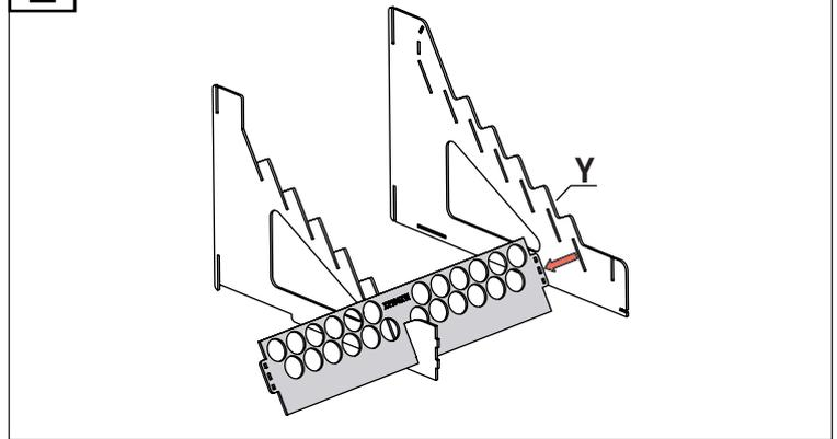
Montieren Sie das Teil Y gemäß der Abbildung.
