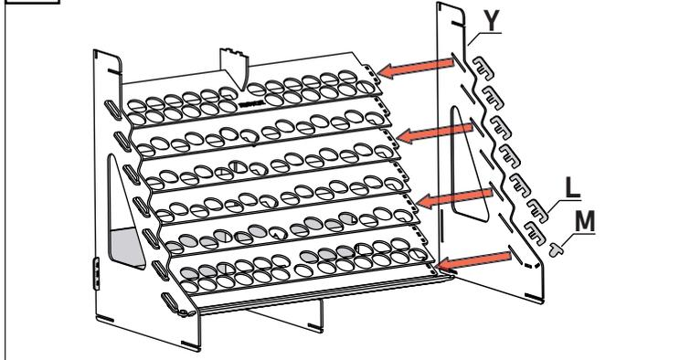
Montieren Sie die zweite Teil Y. Befestigen mit den Elementen L und M (wie im Schritt 3 gezeigt).
