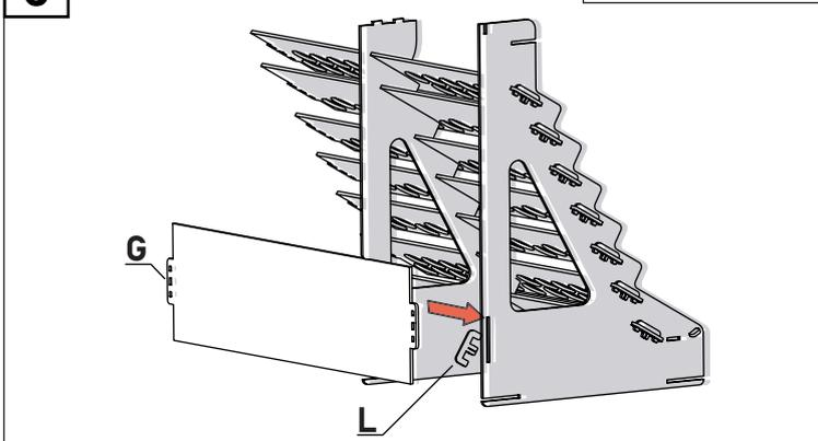
Drehen Sie den Organizer mit der Rückseite zu sich hin und montieren das Teil G gemäß der Abbildung. Befestigen mit dem Element L (wie im Schritt 3 gezeigt).
