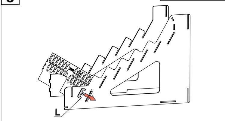
Befestigen Sie das montierte Teil mit dem Element L.
