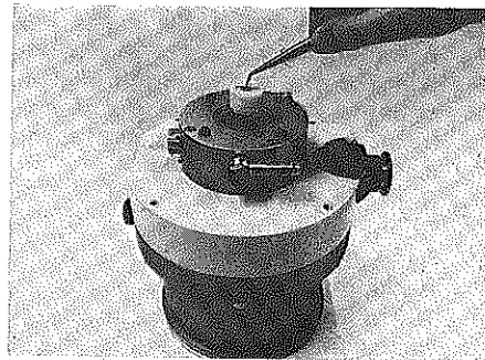
Fig. 12 Betriebsmittelspeicher entnehmen Take out operating agent reservoir Enlever réservoir de l'agent moteur
