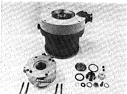
Fig. 22 Pumpe demontiert Disassembled pump Pompe démontée
