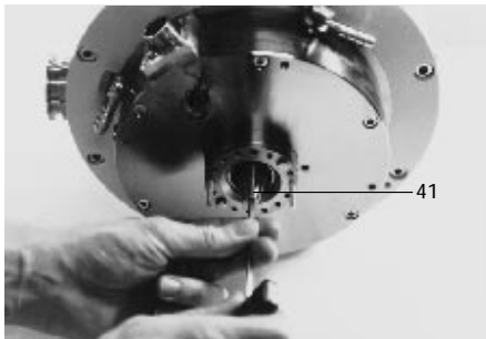
Fig. 29 Spritzmutter 49 einschrauben (Linksgewinde) und anziehen Screw in splash nut 49 (left-hand-thread) and tighten Visser l'écrou de barbotage 49 (filet à gauche) et serrer
