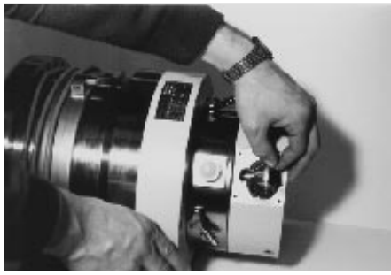
Fig. 18 Steckverbindung 83 zur Betriebsmittel- pumpe lösen Removing operating medium pump plug and socket connection 83 Enlever le connecteur mâle-femelle 83 de la pompe du fluide d'exploitation
