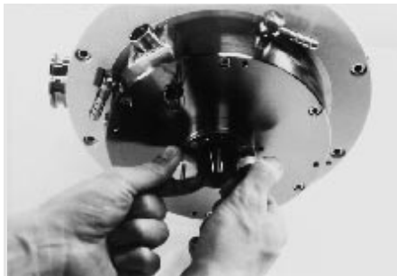
Fig. 21 Rotor 48 ist blockiert Rotor 48 is locked Le rotor 48 est bloqué
