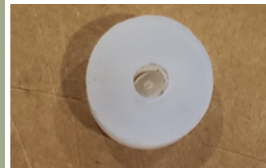
Trou dans la rondelle en silicone pas complètement percée
