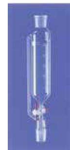
11. Embudo de Presión Compensada con Llave de Vidrio
