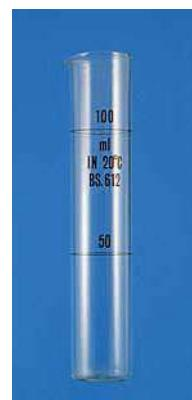
9. Tubo de Nessler para Colorimétrica Forma Alta sin Pico
