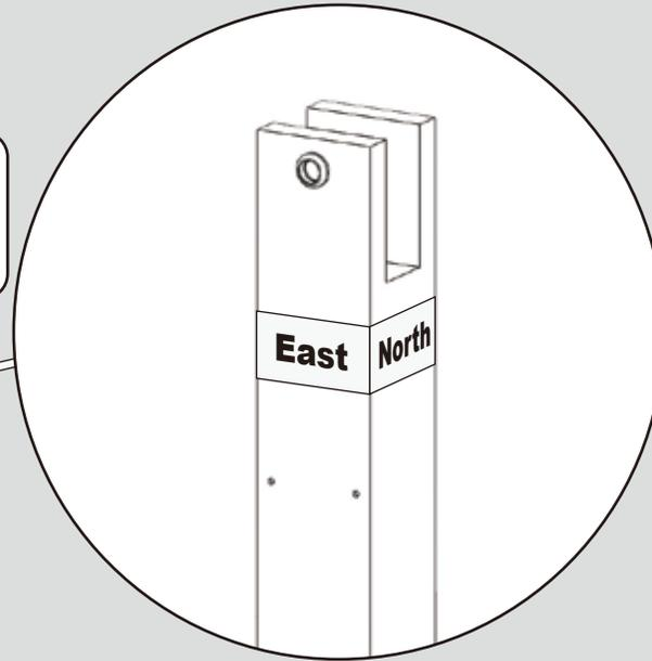
Il y a 4 panneaux indiquant la direction (Sud, Nord, Ouest, est) sur le poteau principal. Utilisez la boussole pour placer correctement le levier principal afin que le Tracker puisse suivre correctement le soleil.
