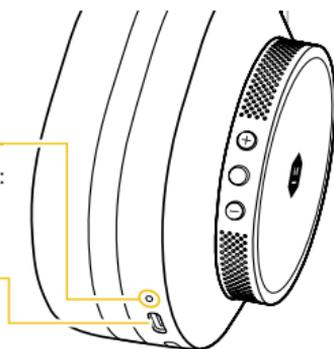
ANC 性能に特化した 4 つのマイクで環境ノイズを除去します。通話品質に特化したマイクを 4 つ追加し、クリアな通話を実現します。各マイクの周囲に音響調整されたメッシュとマイクキャビティを配置し、風切り音の低減や外来ノイズのフィルタリングを実現します。
