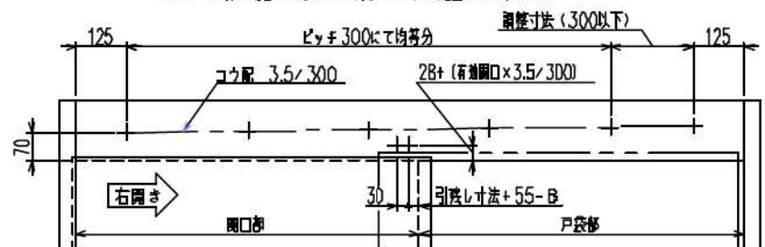
レール、戸当り金具取付用穴位置図(点検口側より見る)
