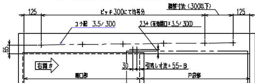
レール、戸当り金具取付用穴位置図(点検口側より見る) ※スチール枠の場合はM5(P=0.8)のタップ加工をして下さい。
