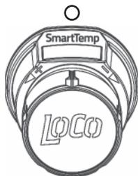
2. Abra completamente la válvula del tanque LP girándola en sentido contrario a las agujas del reloj.
