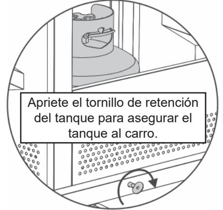
Apriete el tornillo de retención del tanque para asegurar el tanque al carro.
