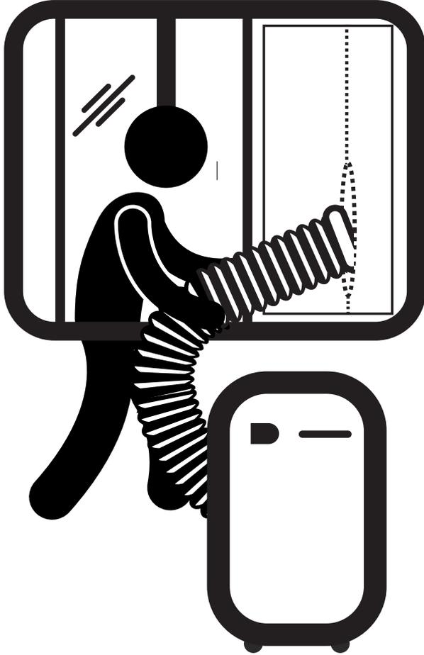
Inserte la manguera de escape del aire acondicionado a través del orificio en el sello del ventana. Cierre la cremallera hasta que la manguera de escape de aire esté asegurada. La junta del ventana ya está lista para su uso, puede enchufar y encender el aire acondicionado.
