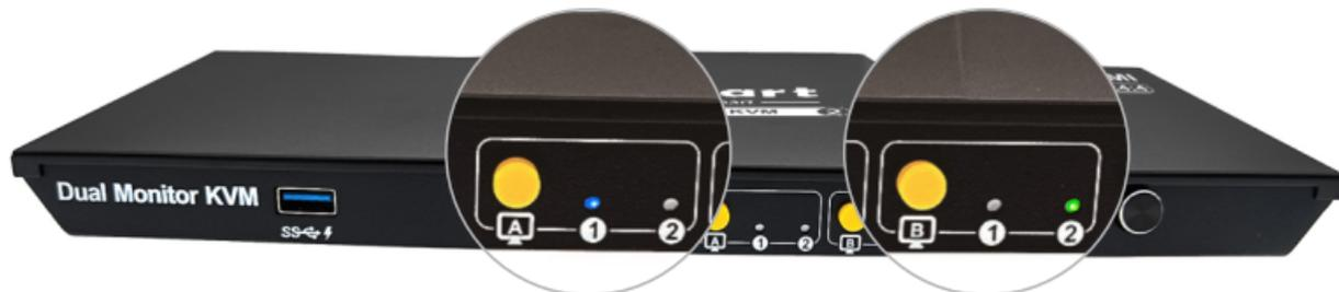
→ [A]/[B] ボタンを押して、表示モードで対応するモニターの PC を切り替えます。 2.
